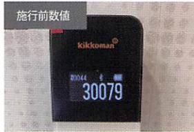
施工前のATP値は30,079
